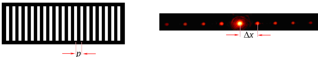
Figura 1. Parámetros de la difracción por una red de difracción de periodo p .
